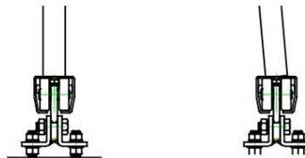
6. Utilisez toujours les roues d'extrémité et la porte, ou bien prévoyez un système pour maintenir l'extrémité en porte-à-faux de la porte bloquée et soutenue, afin d'empêcher tout balancement et de décharger une partie de la charge sur les roues porteuses des chariots lorsque la porte est ouverte ou fermée (le postes les plus stressants) ;
