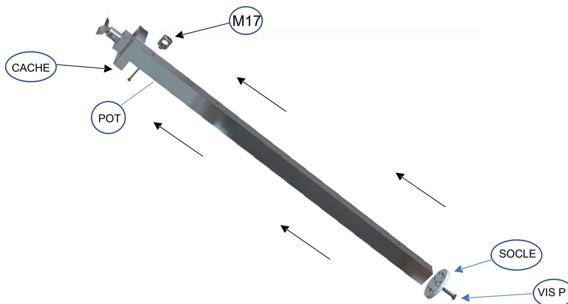
A l'aide de la Vis (A), fixer le support de fixation (C) sur le poteau (POT). Veillez à mettre le repère qui a été fait lors du perçage au sol dans la même ligne que le centre de la rainure qui est sur le poteau. Mettez du frein filet sur la vis (A) avant de la serrer (frein filet non fourni).
