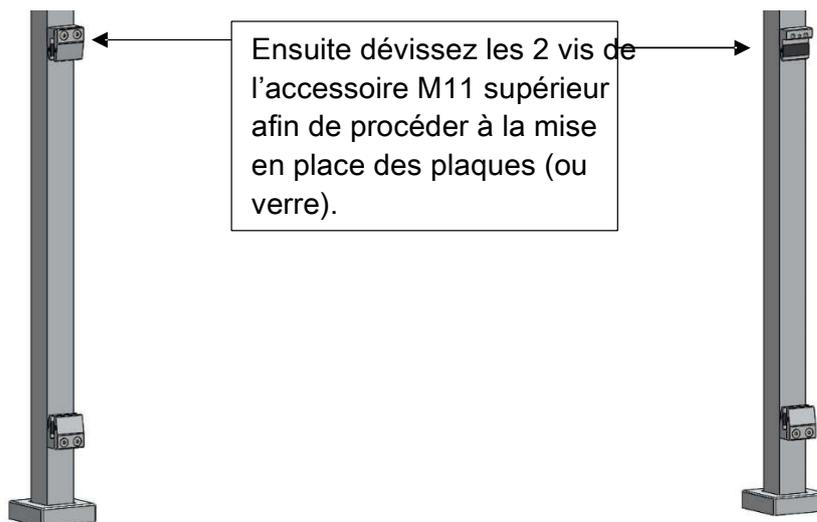
Mettez la plaque sur les accessoires M11 et ensuite remontez les parties de l'accessoire M11 précédemment démontés. Resserrez toutes les vis des accessoires M11.
