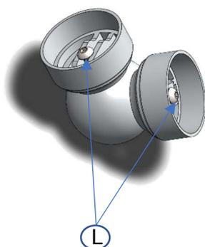
Quand la main courante est positionnée correctement, vous devez coller le ou les assembleurs (M15) avec la main courante (M3). Le coude articulé (M1) ne sera collé qu'au dernier stade du montage afin d'obtenir une finition parfaite.
