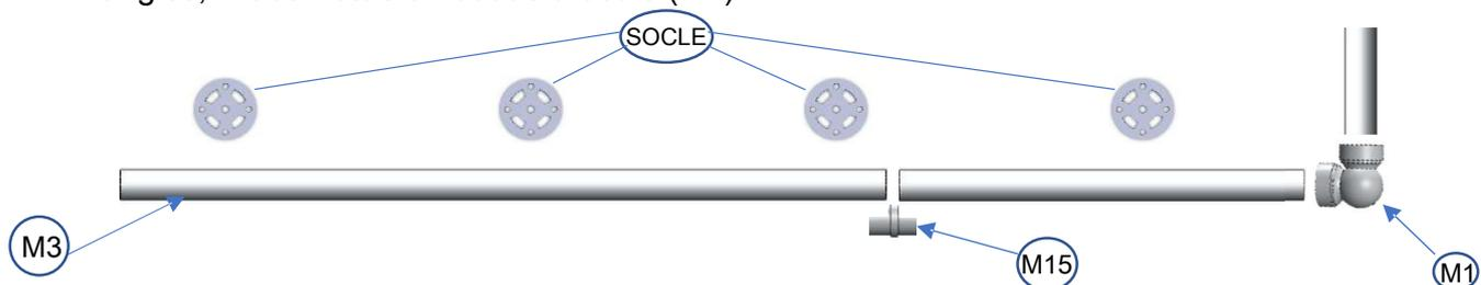
Pour régler l'angle du coude articulé (M1), il suffit de desserrer une ou les deux vis (L), et établir l'angle voulu.
