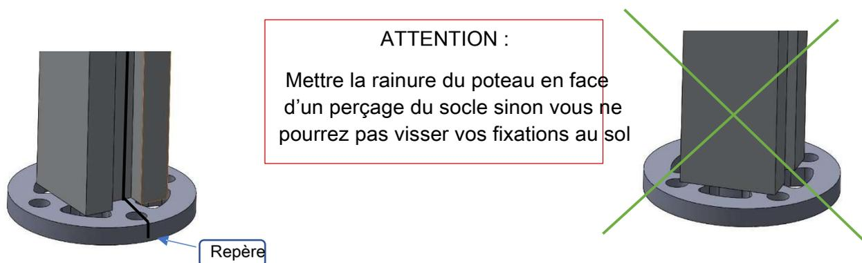
Maintenant fixer les poteaux au sol en serrant vos écrous ou vis utilisés à cet effet.
