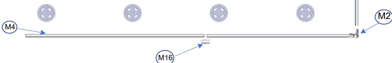
Pour régler l'angle du coude articulé pour les lisses (M2), il suffit de desserrer la vis (P), et régler le coude. Puis, resserrez la vis.
